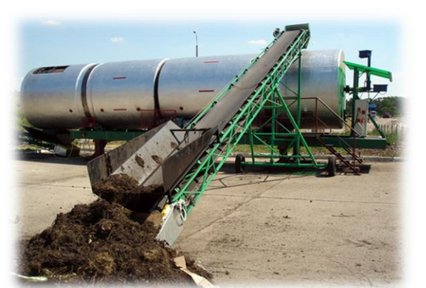
Rysunek 42 Komposter do przetwarzania odpadów zielonych, Machnacz (foto „Saniko” 2013r)
